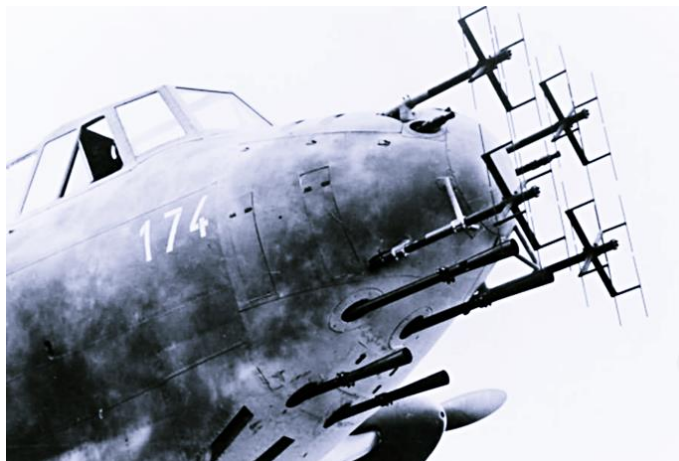
Ilustracja 33. Przód Dorniera 217N z charakterystycznymi „rogami” radaru pokładowego Lichtenstein. Źródło: www.worldwarphotos.info .
